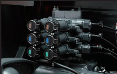
ペーラ、ラップ作業などの同時操作に対応。流量調整付補助コントロールバルブ3連標準装備
