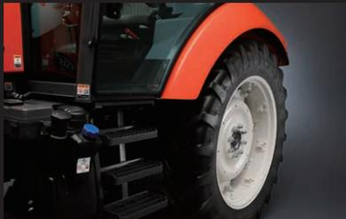
作業機操作を容易化する3P外部操作スイッチ付き。幅狭トレッド用フェンダ
